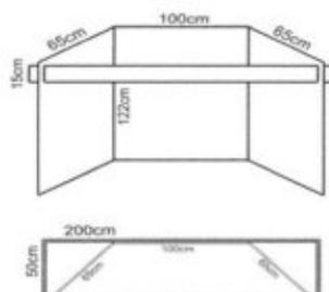
Figura 1 – Layout do estande modelo padrão e planta baixa: baicão – estande.
