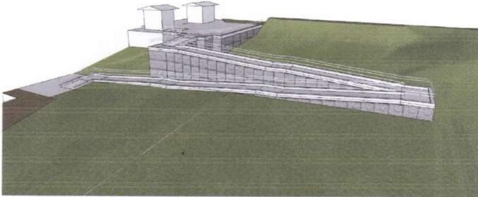
Vista do Empreendimento, com as movimentações de terra, instalações de gabiões, rampa em concreto, com mureta e guarda corpo, passeio nivelado e pavimentado.
